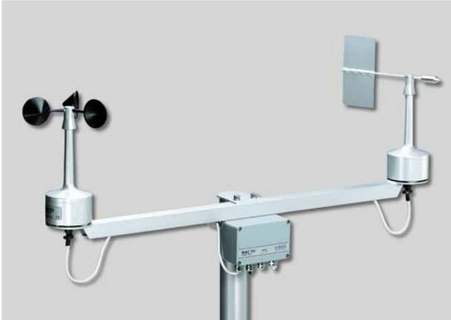
WA15以安装到一长横杆上精确测量的传感器为基础，专为苛刻风测量应用领域而设计。
